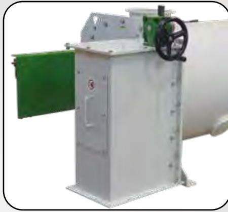
Händliche frontale Entleeröffnung aus Kohlenstoffstahl
