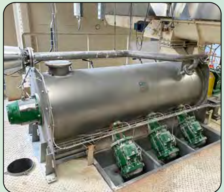
KCV Mischer aus 304 Edelstahl für Kartoffeln Abfälle
