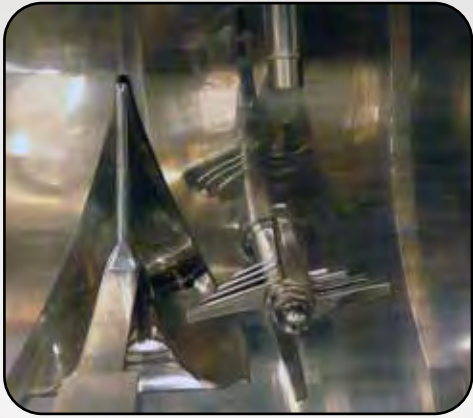
304 Edelstahl Spiegelpolitur Pflugschar, Messerkopf und Flüssigkeitzugaben
