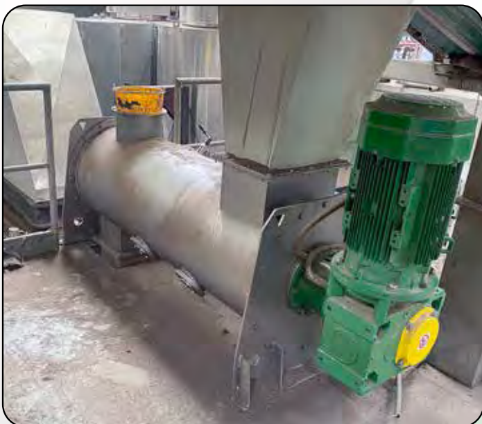
KCV Mischer aus 304 Edelstahl für Düngemittel
