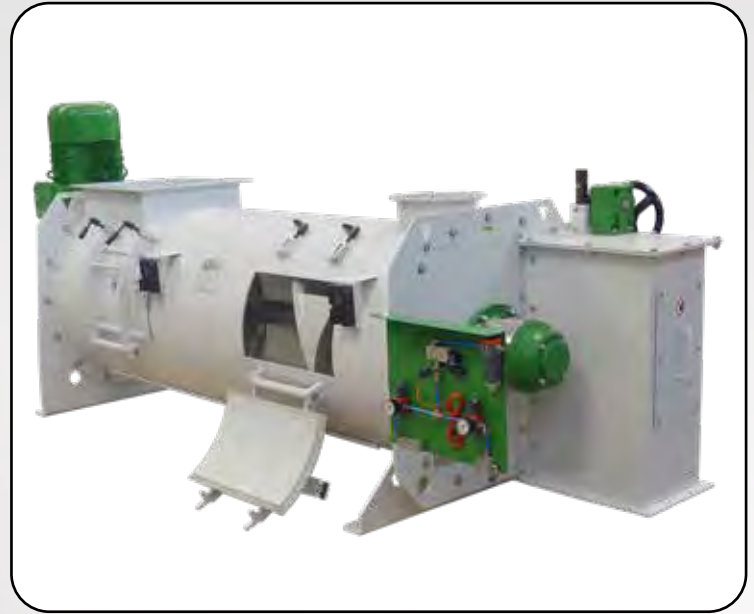
KCF kontinuierliche Mischer aus Kohlenstoffstahl für Lebensmittelabfälle
