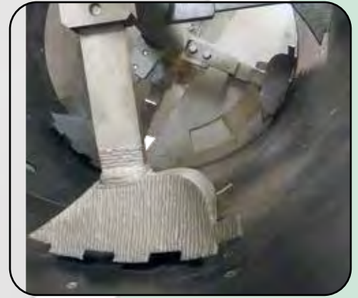
verboltzt, gezahnt Pflugschar aus 304 Edelstahl mit WK Schweißauftragung
